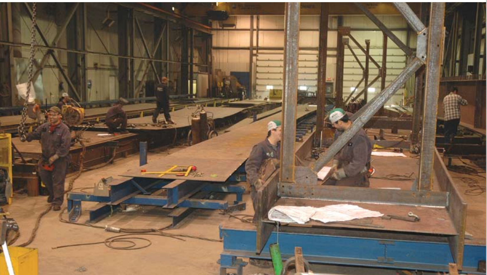
On fabrique en pièces détachées d'imposantes structures comme celle du port méthanier de Saint-Jean au Nouveau-Brunswick.
