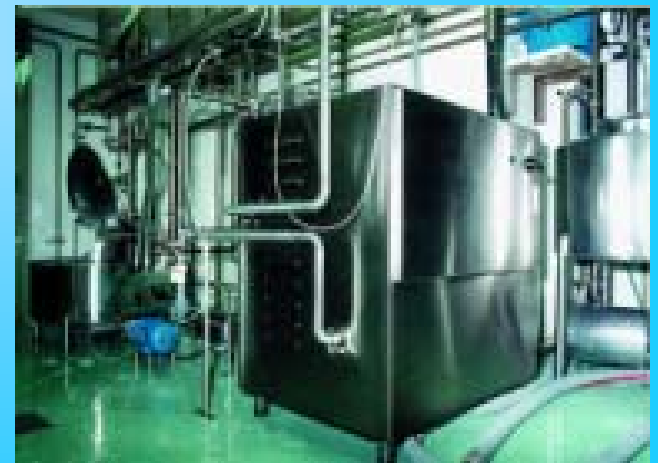
Utilisation du chauffe-fluide à induction pour la pasteurisation de liquide
