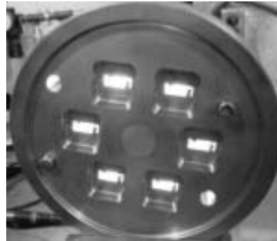
Figure 1 : Photographie d'une filière d'extrusion (la filière produit six pièces à la fois)
